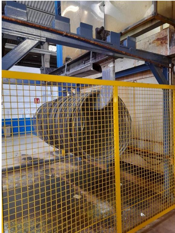
Ejemplo de bobina de alambón al final de un proceso de baños. Fuente: Kamax
