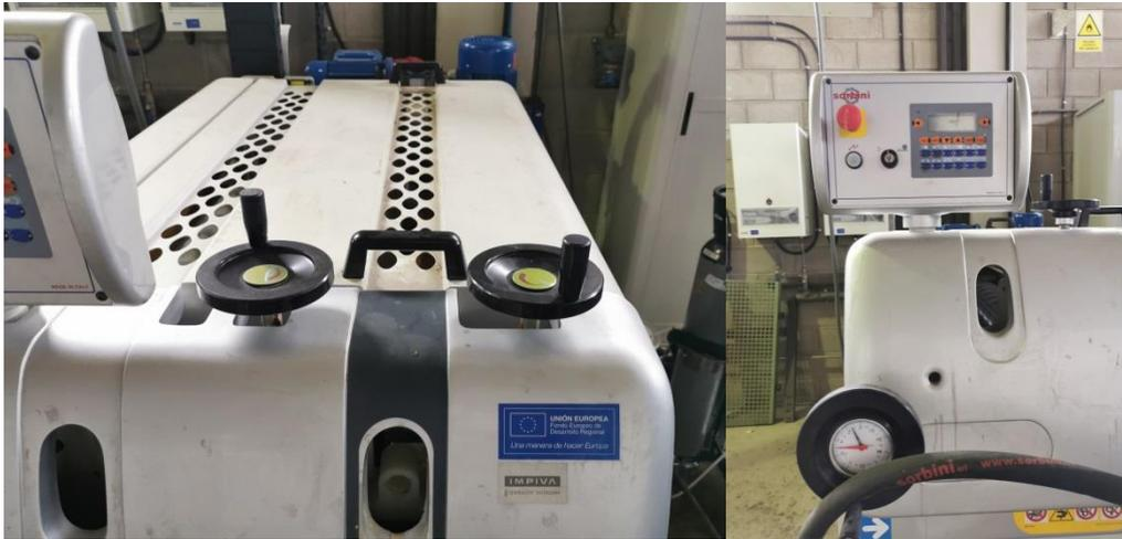
*Sistema de ajuste manual de la máquina barnizadora.*
